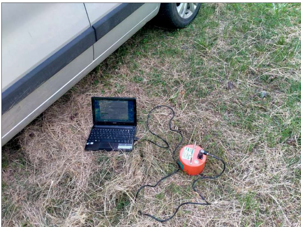
Fig. 10: geofono triassiale utilizzato per l'acquisizione di microtremori
